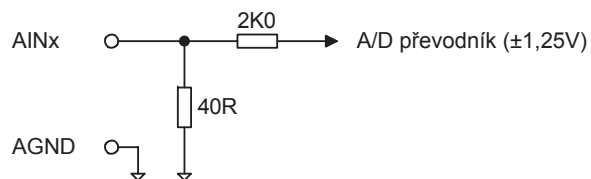
Obr. 1. Zjednodušené schéma vnitřních obvodů analogových vstupů.
