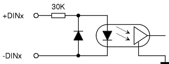
Obr.2B. Zjednodušené schema obvodů digitálních vstupů modulu MU-622.
