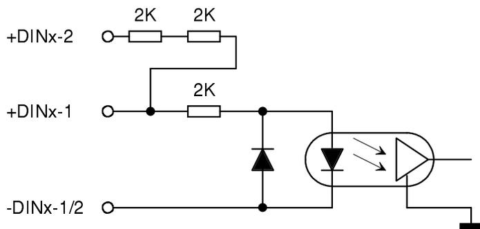
Obr.2A. Zjednodušené schema obvodů digitálních vstupů modulu MU-621.
