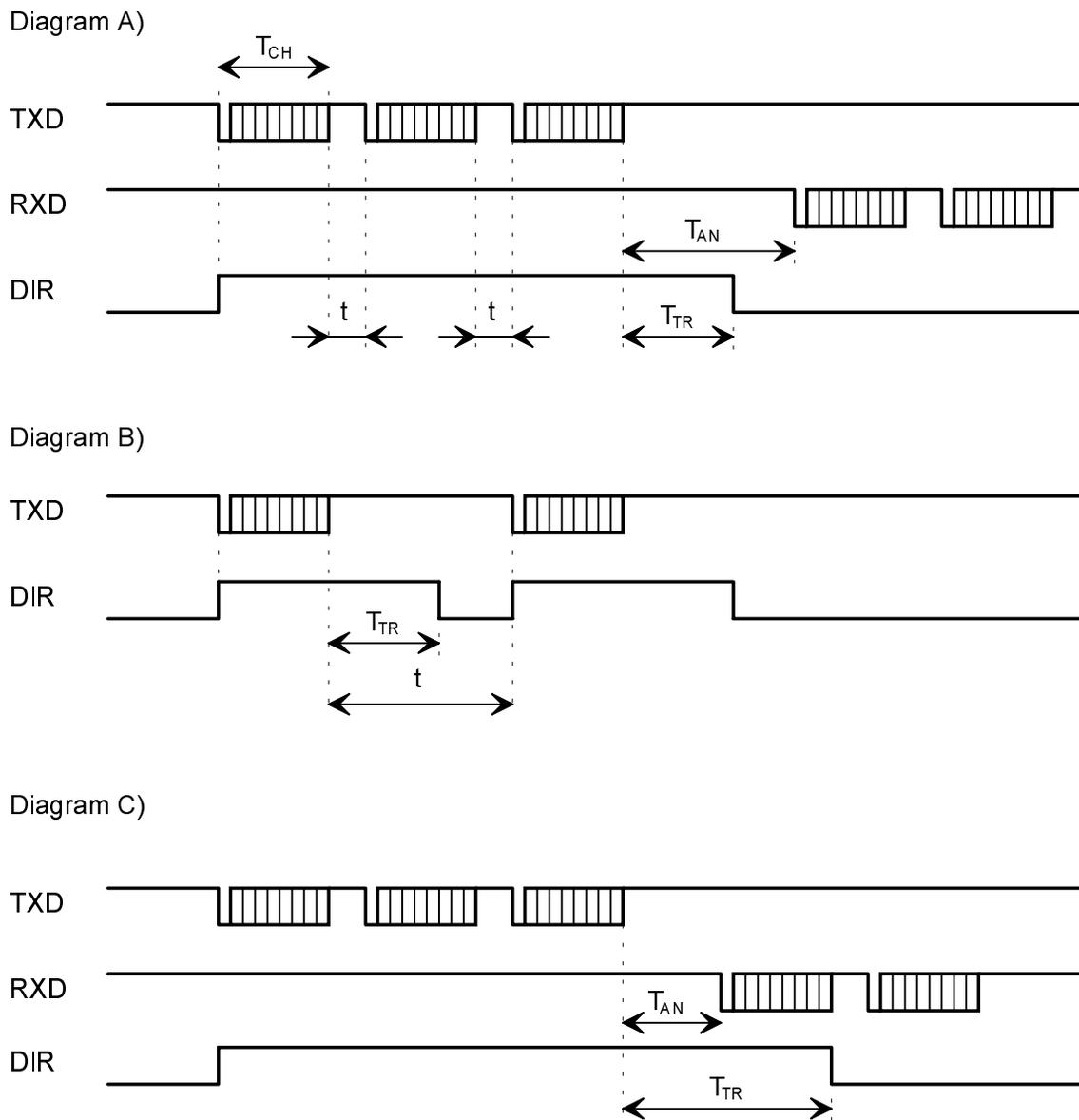
Obr.6. Časové poměry automatického řízení RS-485 (ADFC)
