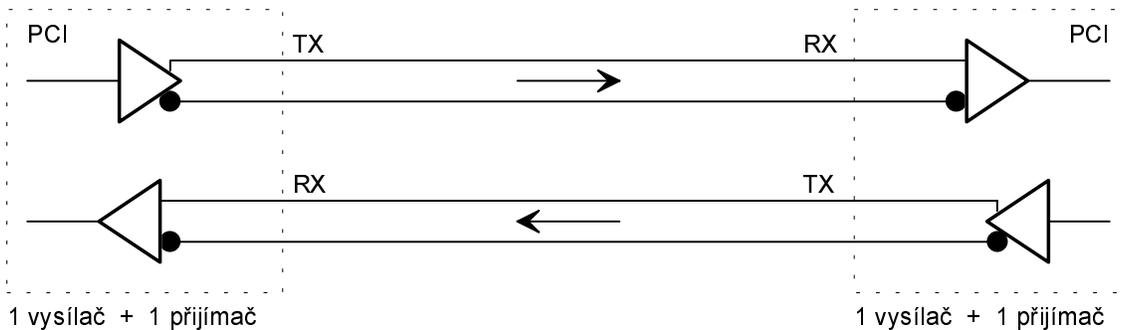
Obr.5. Schema zapojení linky standardu RS-422.
