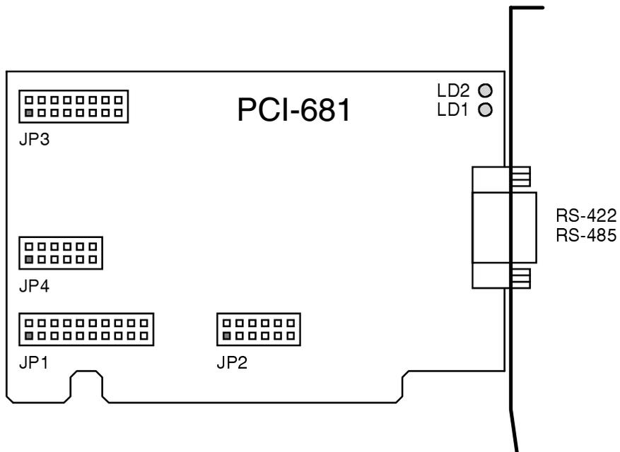
Obr.1. Rozmístění důležitých prvků na desce PCI-681.
