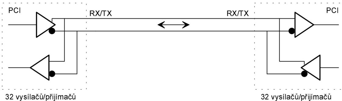
Obr.6. Schema zapojení linky standardu RS-485.
