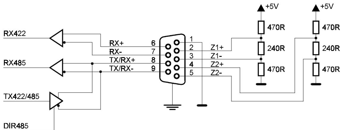
Obr.4. Schema zapojení konektoru karty PCI-681.
